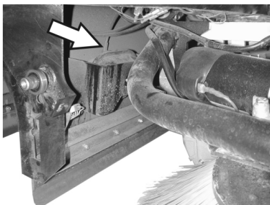
Підключення шлангів до мембранного механізму вакуумного регулятора системи опускання бічної щітки.
